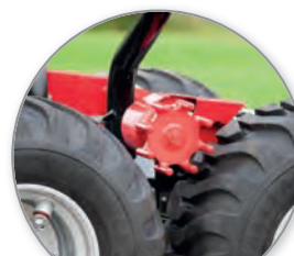
Assistance motrice par galets sur 14DP - 4WD
